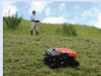
無線草刈機の運用に対応した傾斜
